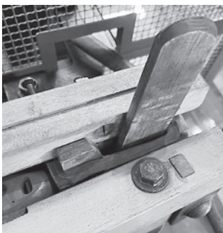
写真2 革製のピッカーと杼箱 （はたや記念館ゆめおーれ勝山で撮影）
